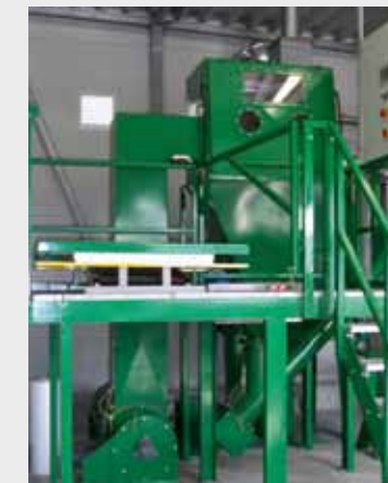
Von der Baugrube zur fertigen Halle mit Umfüllanlage (l. Bedienpodest mit Materialaufgabe; r. Containerabfüllung).
